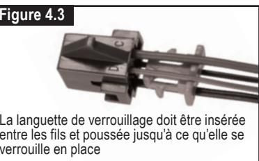
10. Insérez la grande languette de verrouillage bleue qui se fixe aux bornes dans le connecteur à 4 fils. (figure 4.3)
